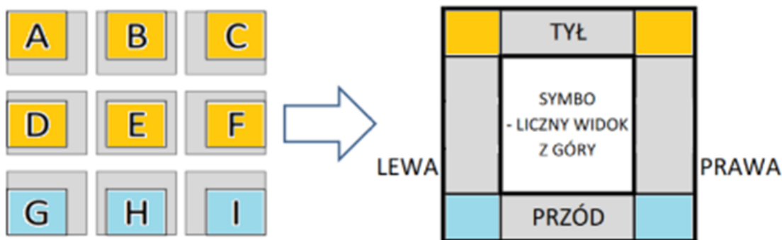
Rys. 6. Oznaczenie rodzajów stóp (widok z góry) pergoli SB400.
